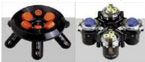
Obr. 14.1 Úhlový rotor (vlevo) a výkyvný rotor.
