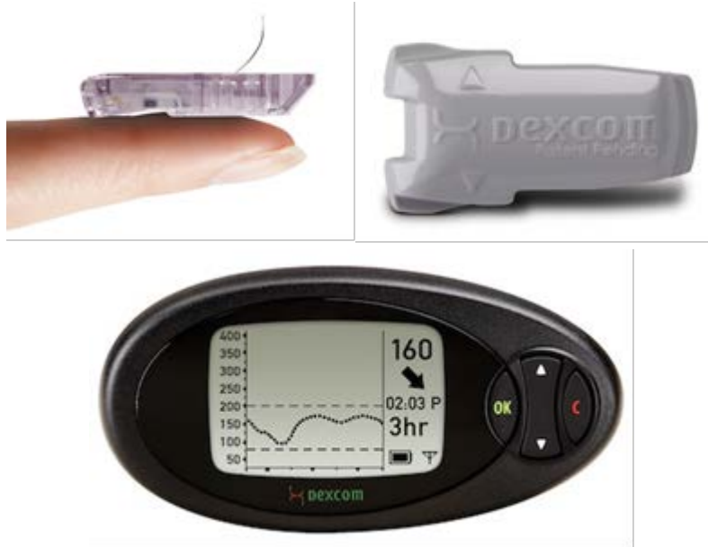
Obr. 13.37 CGM senzor (vlevo nahoře), vysílač (vpravo nahoře) a monitor.
