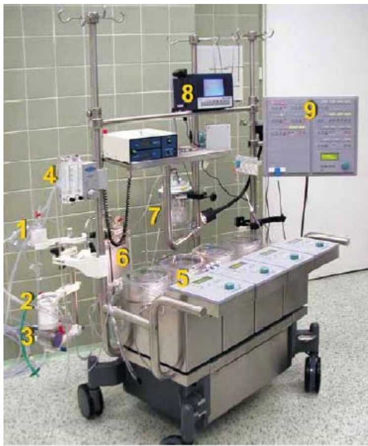
Obr. 13.3 Přístroj pro mimotělní oběh připravený k připojení hadicového setu z operačního pole. 1. Arteriální filtr, 2. oxygenátor, 3. výměník tepla oxygenátoru, 4. průtokoměr plynů se směšovačem, 5. jednotlivé moduly čerpadel, 6. venózní rezervoár, 7. kardioto-mický rezervoár, 8. monitor ke sledování PO_2 , saturace O_2 , hematokritu a teploty, 9. řídicí jednotka přístroje pro mimotělní oběh.
